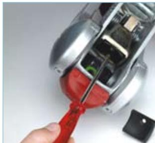
Ferodo posteriore: Togliere le viti Torx. Sostituire il ferodo e chiudere le viti Torx.
