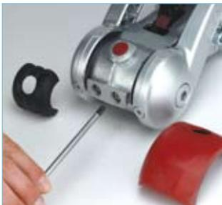
Ferodo anteriore: togliere la protezione Soft-Dock. Togliere le due viti Torx. Sostituire il ferodo. Chiudere le viti Torx e posizionare il Soft-Dock.
