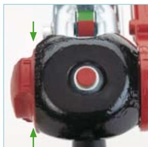
Ad agganciamento effettuato si evidenzia lo stato di usura dei ferodi dell' AKS™ 1300. Se la distanza (vedi freccia verde) è maggiore a 0 mm, i ferodi sono ancora sufficienti (vedi libretto istruzioni). Nel caso di un'usura eccessiva i ferodi sono semplicemente sostituibili.
